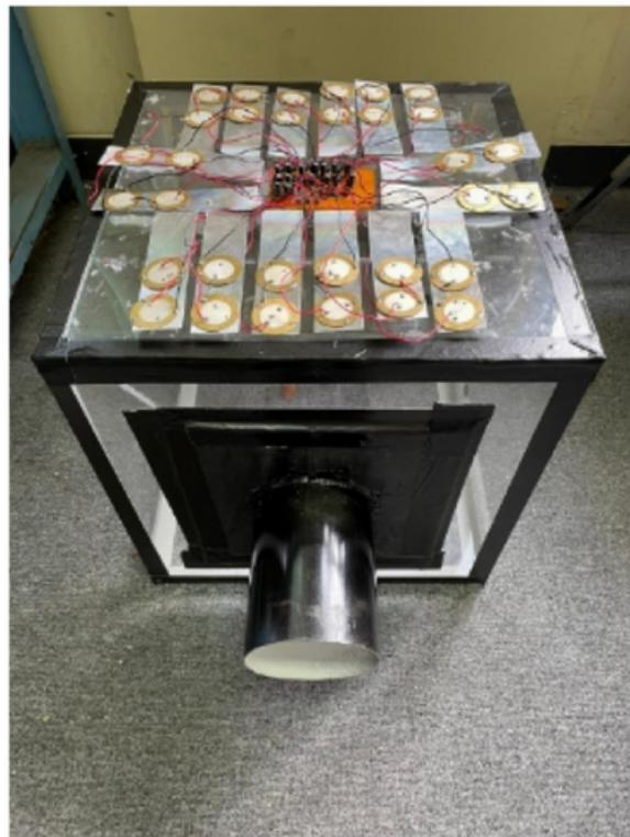
Gambar 1 Desain Purwarupa Peralatan Konversi Energi Suara Menjadi Energi Listrik
